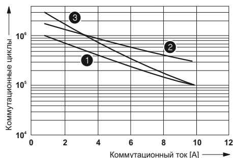
Срок службы электрического устройства
