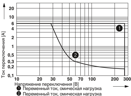
Электрическая мощность отключения для PLC...24DC/1/ACT с 1 замыкающим контактом
