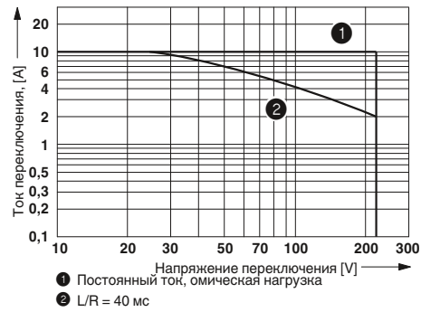
Мощность отключения постоянного напряжения
